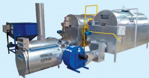
Conjunto de Secadores Rotativos com alimentador de Fornalha e Fornalha Elétrica Automatizado
