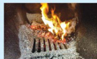
Alimentador de Fornalhas Automatizado com queima de pellets e cascas de Noz Pecan
